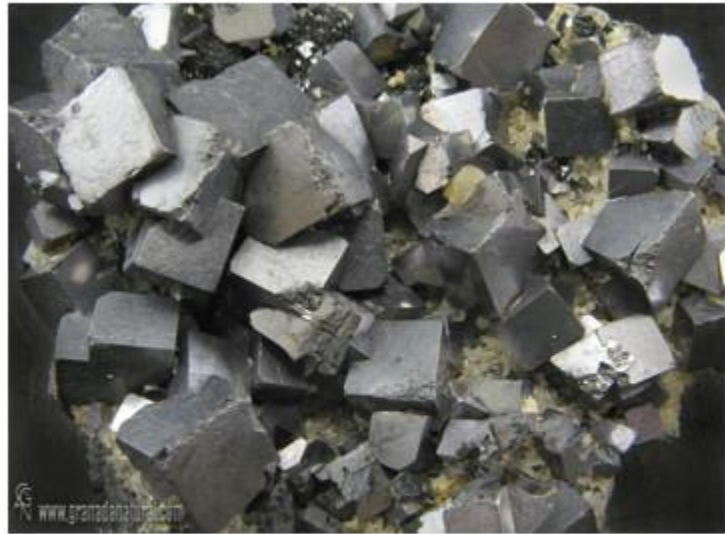
La galena es un mineral del grupo de los sulfuros. Forma cristales cúbicos, octaédricos y cubo-octaédricos. La disposición de los iones en el cristal es la misma que en el cloruro de sodio (NaCl), la sal marina. Su fórmula química es PbS .
