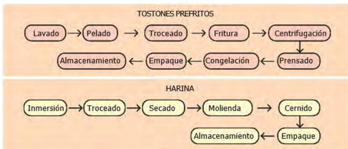
Figura 4. Diagrama de flujo para la elaboración de tostones prefritos (arriba) y harina de plátanos (abajo)
